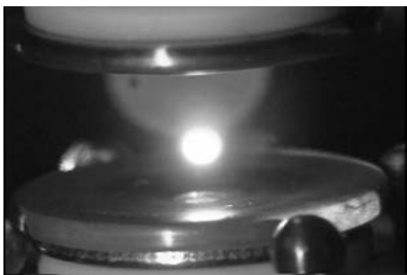
図3 静電力により浮遊させた溶融金属球
