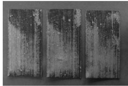
図 2 リサイクル押出材の腐食生成物除去前の耐食性試験後の外観
