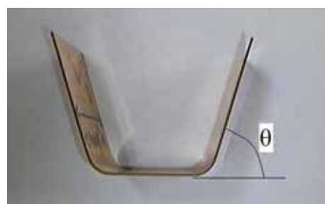
図9 曲げ・スプリングバック後の板形状
