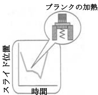
図9 Mg合金温間成形におけるスライドモーション
