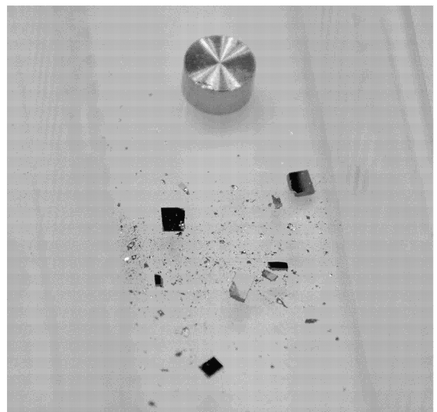
図9 SUS304加工後に破壊したシリコンチップ
