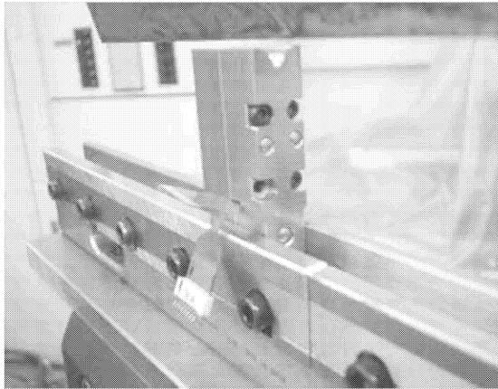
(a) プレスブレーキ機に金型設置概観
