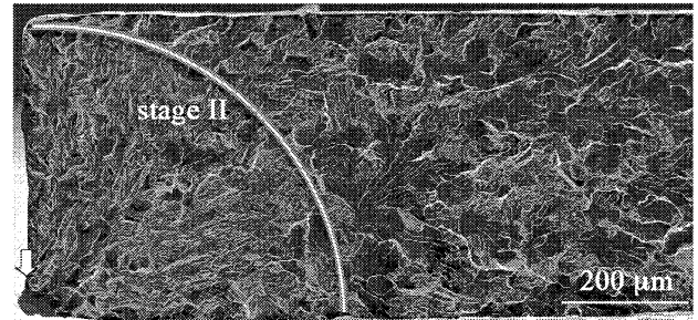
(a) No. 1 未加工材 ( \sigma_{\text{max}}/\sigma_B=0.77 , N_f=497,844 回)
