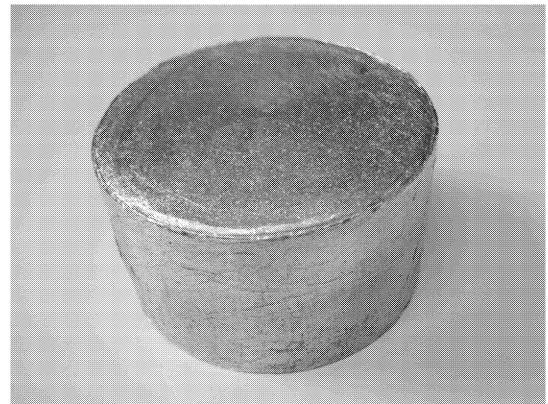
図 3 プリカーサ(押し出材)作製用成形体 (AZX911 マグネシウム合金)
