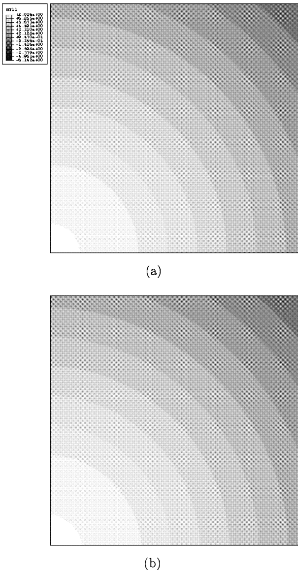
図 7 (a) 再初期化手法ならびに (b) 提案した方法を用いて計算した円形界面の場合のレベル集合関数分布
