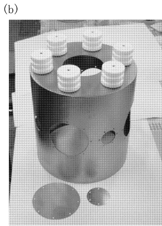
図1 (a)真空容器内部。奥側に ICP プラズマ源，左側にマグネトロンスパッタ源。(b) ライナー型陽極とテフロン碍子。
