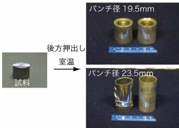
図7 鍛造前後の試料の概観写真
