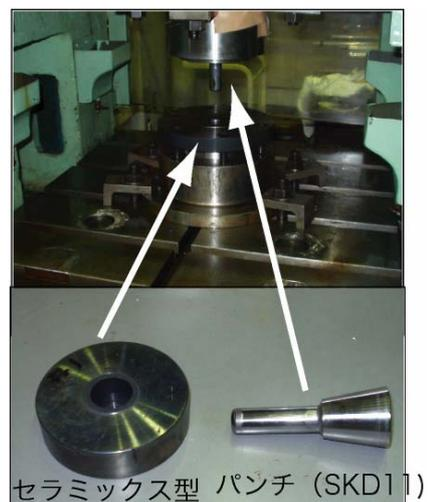
図2 鍛造部のセラミックス型及びパンチ
