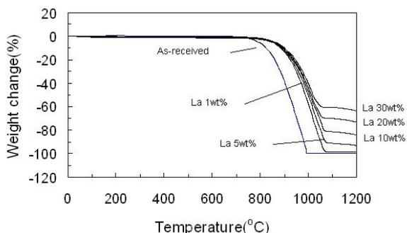
図5 リン酸ランタン処理した黒鉛粉末のTG曲線
