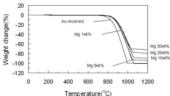
図3 リン酸マグネシウム処理した黒鉛粉末のTG曲線
