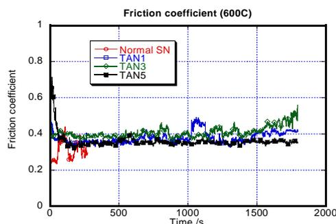
図6  $\text{Si}_3\text{N}_4$ 及びMo分散 $\text{Si}_3\text{N}_4$ の室温及び高温(600℃)での摩擦係数の時間による変化
