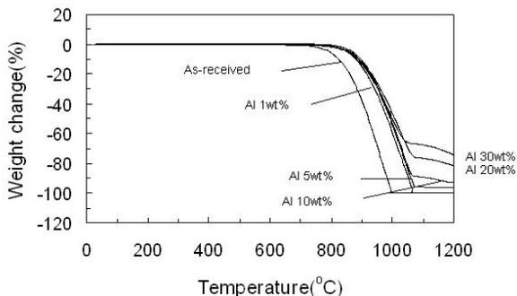
図4 リン酸アルミニウム処理した黒鉛粉末のTG曲線
