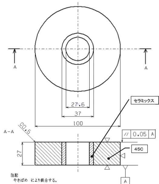
図1 セラミック型の構造
