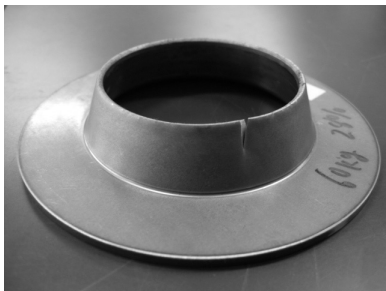
図5 穴広げ成形による割れ発生例 (60キロ鋼)
