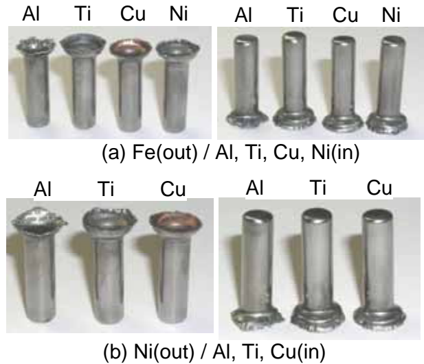
図5 6段絞りした二層クラッド容器
