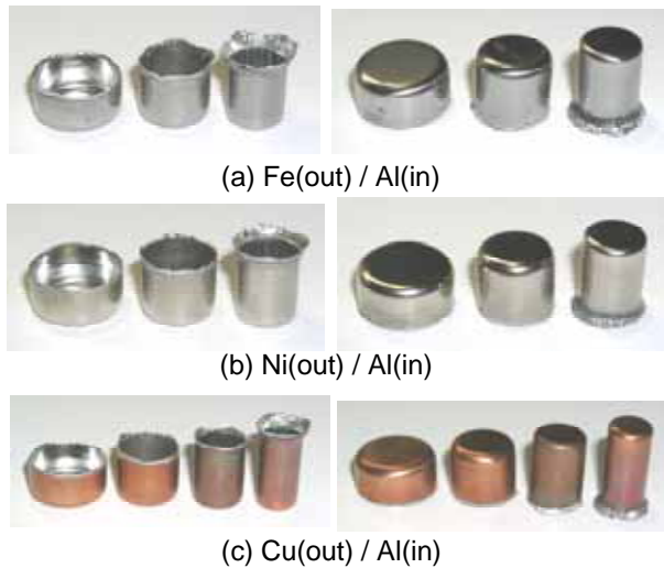
図4 Al板内側の二層クラッド容器
