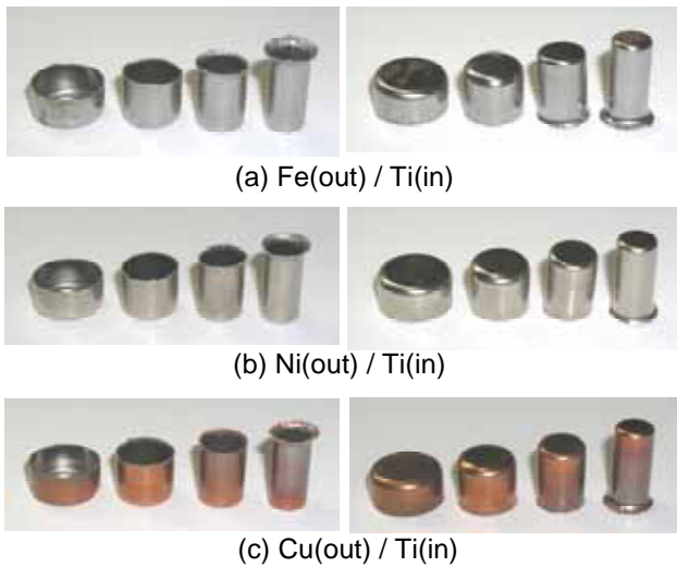
図3 Ti板内側の二層クラッド容器
