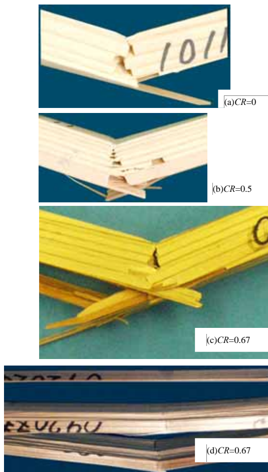
図3 アルミニウム板を接着しない場合の破壊形態 (a)未圧縮、(b)圧縮率 0.5、(c)圧縮率 0.67、中央部、高さ方向に亀裂が進展した例、(d) 圧縮率 0.67、早い時期から層間はく離が発生した例
