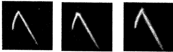
(a) 標準画像 (b) 欠肉画像 (c) ばり画像 図7 計測画像の例
