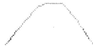
図15 細線化処理された欠肉画像
