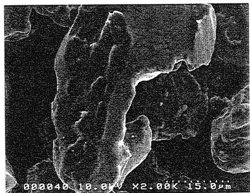
図11. キャビテーション処理後のアルミニウム粉の電顕像
