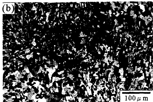
図3 熱処理による Ti-46at%Al-3.5at%Cr 合金の組織変化：(a) 1613K からの空冷により生じたフェザリ \gamma 組織；(b) (a) を 1573K で 3.6ks 焼き戻すことにより形成された \alpha + \gamma 組織。
