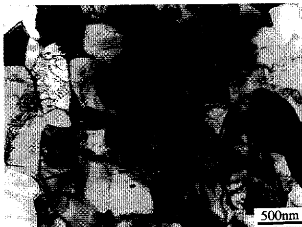
図10 SUS316LのPREP粉末の720ks (200hr) ミリングした粉末の、1073K (800°C) でのHIP焼結体のTEM写真
