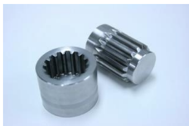
図10 加工油を用いた鍛造事例 ((株) アマダ)
