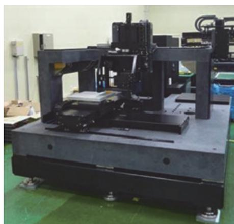
図1 ピコ秒レーザー加工システム
