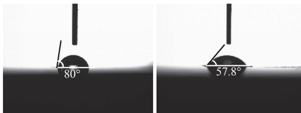
(a) 平面 (b) 微細構造表面
