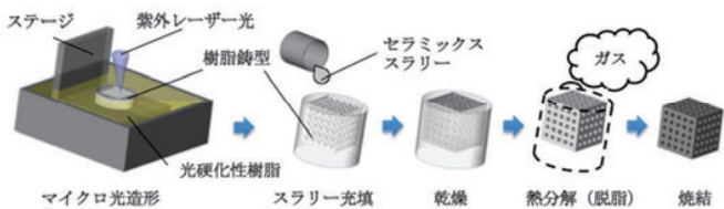
図2 マイクロ光造形モールドイングの作製工程
