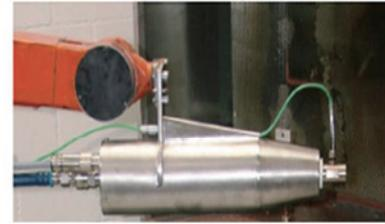
図1 コールドスプレー装置ガンヘッド<sup>12)</sup>
