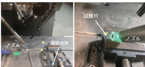
図7 試験片固定の様子ならびにレーザー照射の状況(右)
