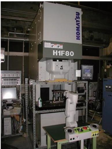
図3 サーボプレスおよびロボット
