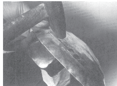
図2 金属工芸に用いられる技法:鍛金 2)
