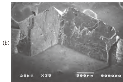
図9 切欠試験片の破面：(a) 方位 A, (b) 方位 B.
