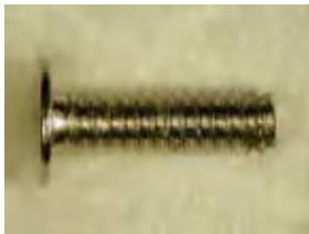
図 10 超鉄鋼で製造したタッピングねじ 15)
