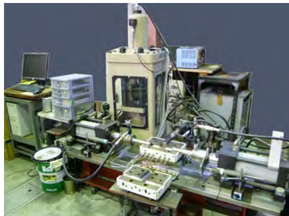
図 12 設計試作した THF 装置の概観（温間成形仕様）
