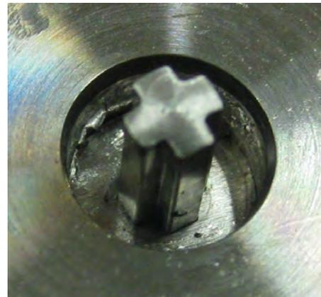
図 14 超音波付加による十字断面形材の押し出し
