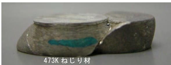
図4 圧縮変形した試料の外観
