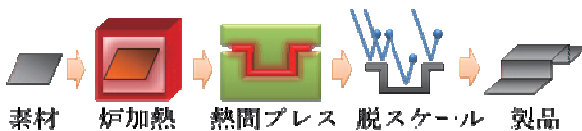
図1 現行のホットスタンピングプロセス
