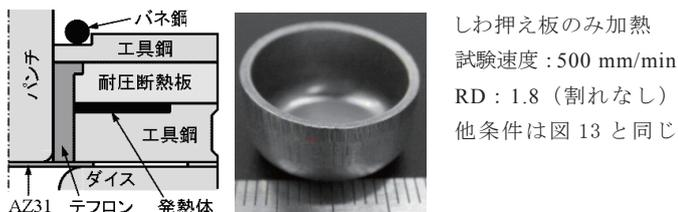
図 14 しわ押え加熱 (100°C) 深絞り試験後の試料
