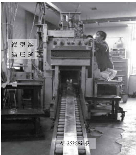
図 2 溶湯圧延直後の Al-25%Si 板
