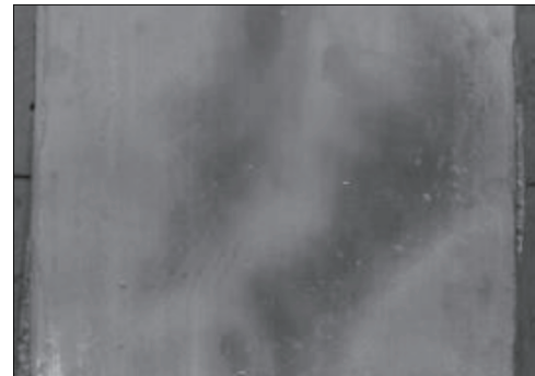
図 4 Al-25%-4%Mg 溶湯圧延板の表面状態
