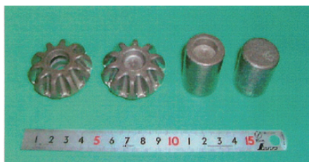
図 20 傘歯車の冷間閉塞鍛造 (アミノ)
