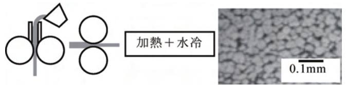
(b) スーパーヒート 50°C で鋳造した板に冷間圧延
