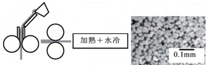
(d) 半凝固鋳造した板に冷間圧延
