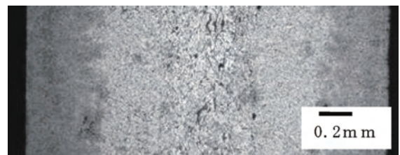
図10 Feを1%添加したAC4C合金のロールキャスト板の断面組織
