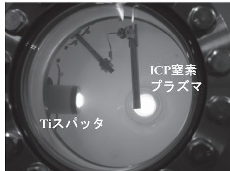
図10 正プラズマバイアス法によるTiNコーティングの様子. Ar/N<sub>2</sub>混合プラズマ. 基材はSKD11パンチブランクで上部から懸架されている.
