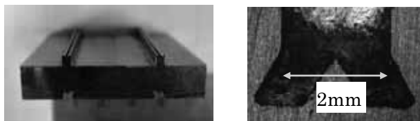
図 19 最適化された溝部形状による接合試験結果
