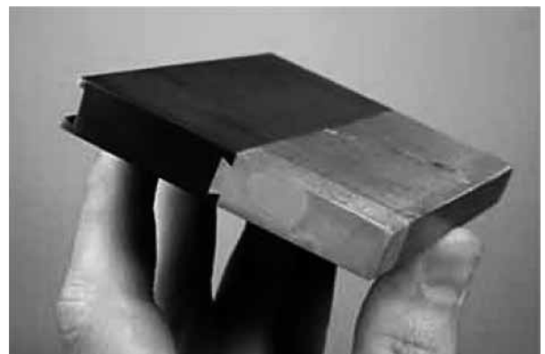
図 12 FSF プロセスによる機械的接合 13)
