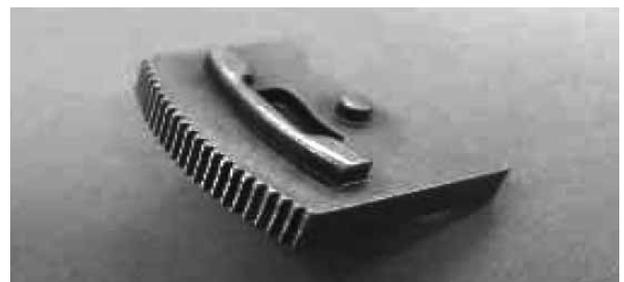
図5 冷間鍛造とファンインブランキングを組み合わせ た自動車部品 (株)秦野精密
