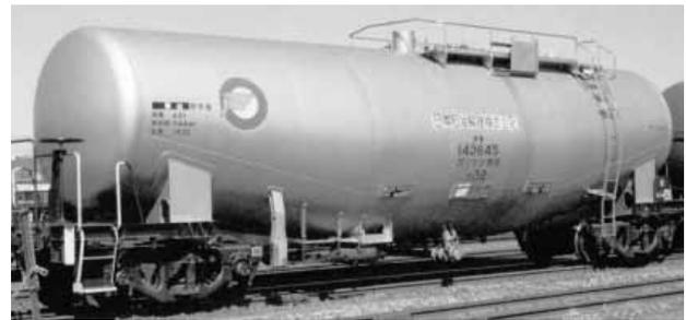
図15 シャーシをなくしモノコック構造にしたタンク車
